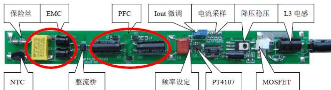
图 1. 非隔离式 LED 日光灯电源
